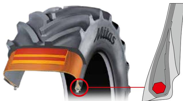
Ajuste firme e seguro do aro graças à tecnologia hexa-core - os arames individuais são dobrados e fixados em formato hexagonal, tornando o talão do pneu resistente, garantindo um torque elevado.
