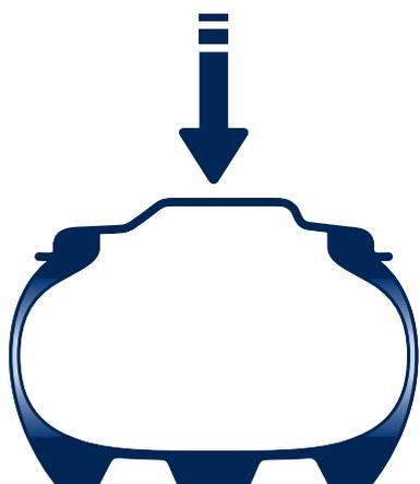
Até 40% mais carga do que um pneu não VF com a mesma pressão - a carcaça robusta do pneu VF absorve a pressão transmitida durante as operações sem comprometer a flexibilidade das paredes laterais.
